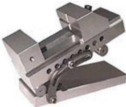
Obrázek 59 Přesný sinusový svěrák bez šroubu
