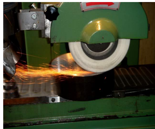
Obrázek 2 Broušení na brusce rovinné
