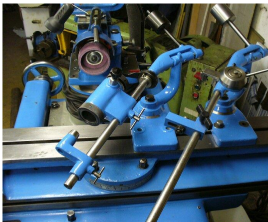
Obrázek 66 Přípravek k upínání ostřených vrtáků na nástrojářské brusce
