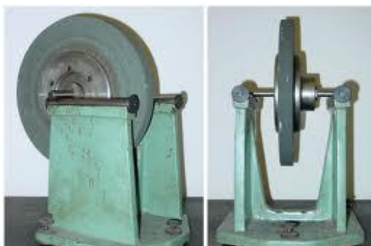
Obrázek 31 Statické vyvažování brousících kotoučů
