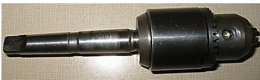
Obr. 59. Tříčelistové sklíčidlo, klíč ke sklíčidlu, redukční pouzdro, vyrážecí klín
