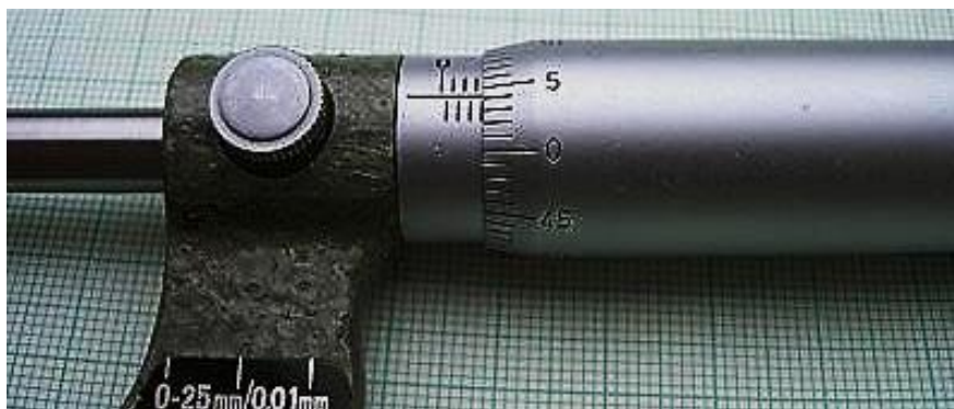
Obr. 8. Skutečný odečet hodnoty (3,54 mm)
