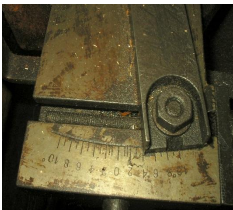
Obr. 75. Výroba kuželů pomocí kopírovacího pravítka
