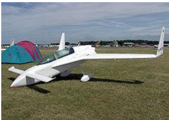
Miniletadlo postavené z kompozitních materiálů
