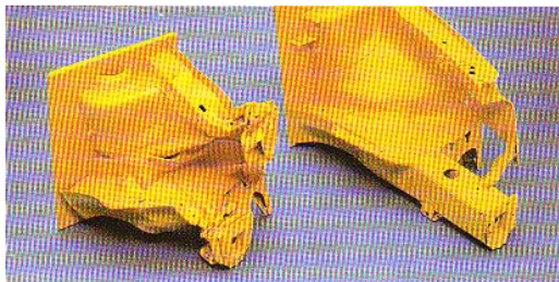
Deformace předního podélného nosníku
